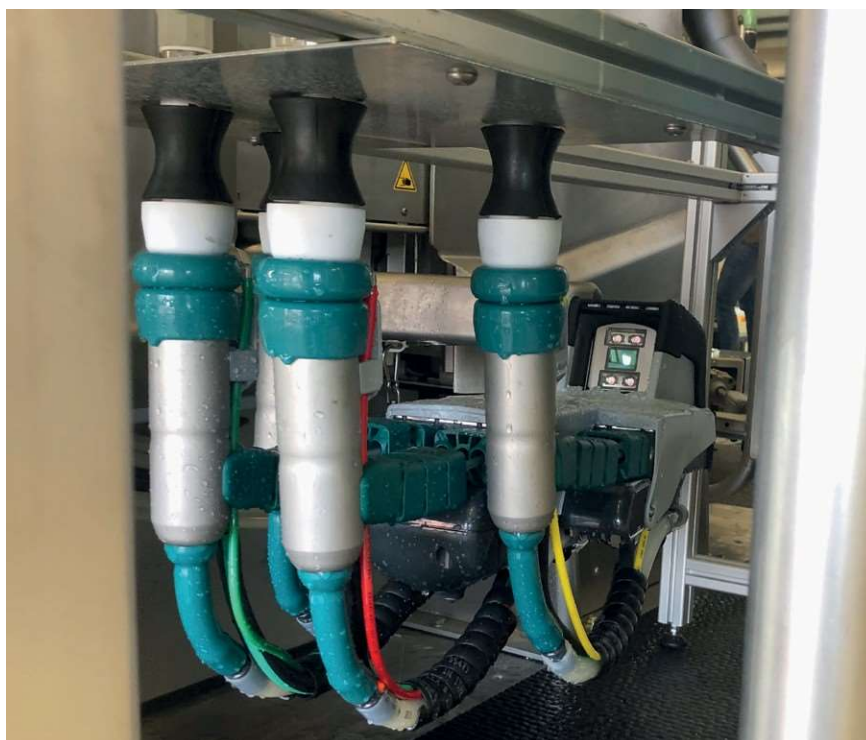
Илл. 2: Искусственное вымя в Монобоксе DairyRobot R9500 GEA (Илл: DLG)
