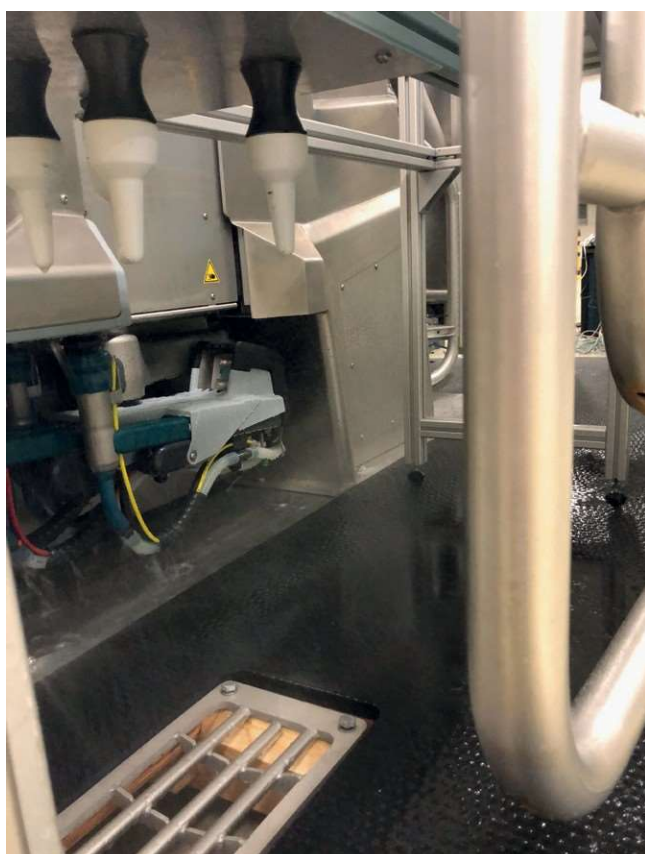
Илл. 6: Промывка аппарата снаружи (Илл: DLG)
